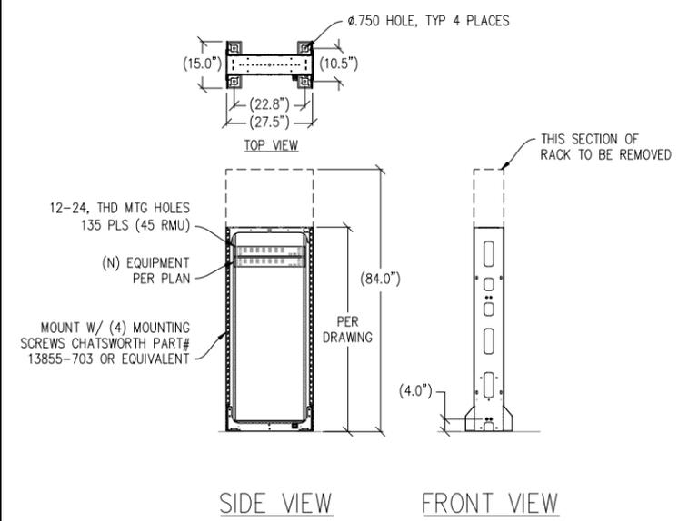
③ 23" SEISMIC RACK DETAIL
