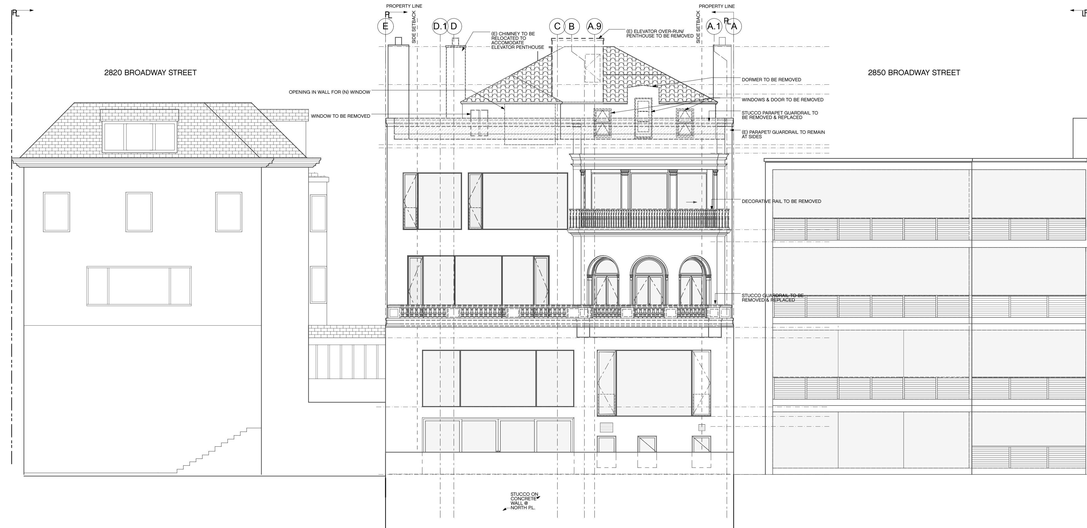
1 NORTH ELEVATION SCALE: 1/8" = 1'-0"
